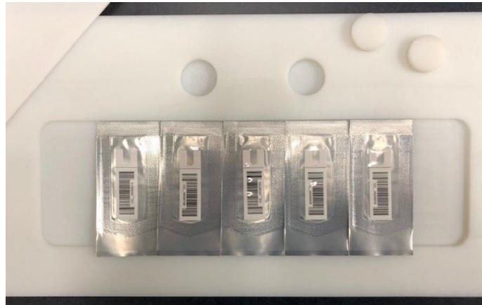
FIGURE 1: B3 dosimeters spaced edge to edge
